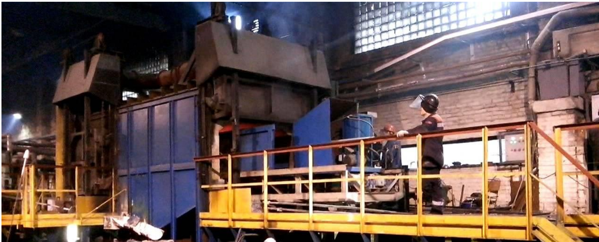
Фото 3. Загрузочная машина выгружает лом в печь
